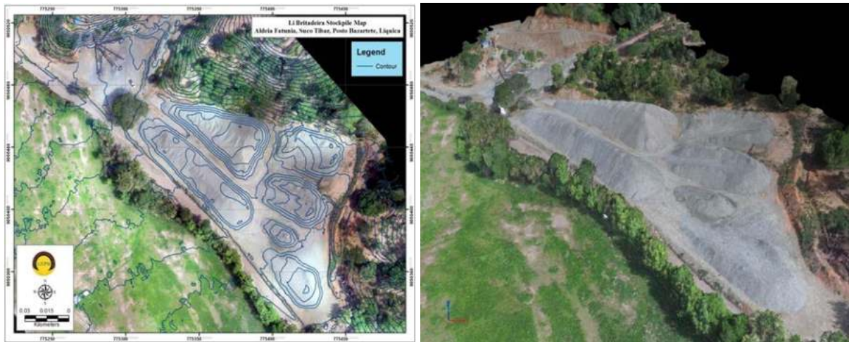
FIGURA 50: MAPAMENTU NO OBSERVASAUN BA VOLUMETRIKU FORNESEMENTU HUSI DRONE
