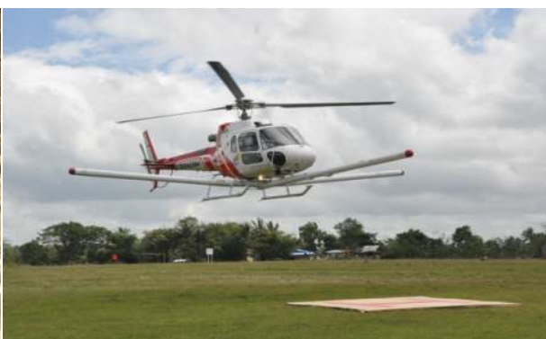
FIGURE 13: ATIVIDADE PESKIZA MAGNETIKU NO RADIOMETRIKU
